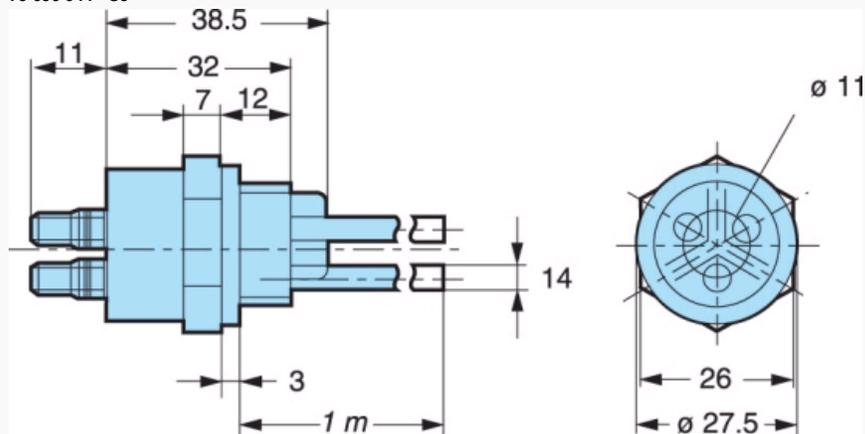
Porte-électrode léger et compact à 3 sondes (inox). Porte-électrode et sonde 1000 mm. Particulièrement recommandé pour distributeurs de boissons et dans le cas où l'espace d'installation est restreint. Température d'utilisation : 80 °C Pression maxi : 2 kg/cm<sup>2</sup>
