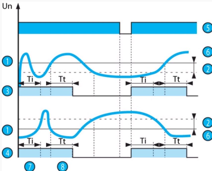
En mode surintensité, si le courant contrôlé dépasse le seuil réglé pendant un temps supérieur à celui réglé en face avant (de 0,1 à 3 s), le relais de sortie s'ouvre et la LED R s'éteint. Pendant la temporisation, cette LED clignote.
