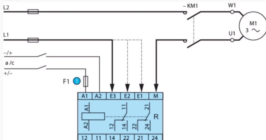
Nota : Dans le cas d'un contrôle de courant continu provenant de la même source alimentant les bornes A1 et A2, la borne M doit être reliée directement au pôle "moins" de cette alimentation.
