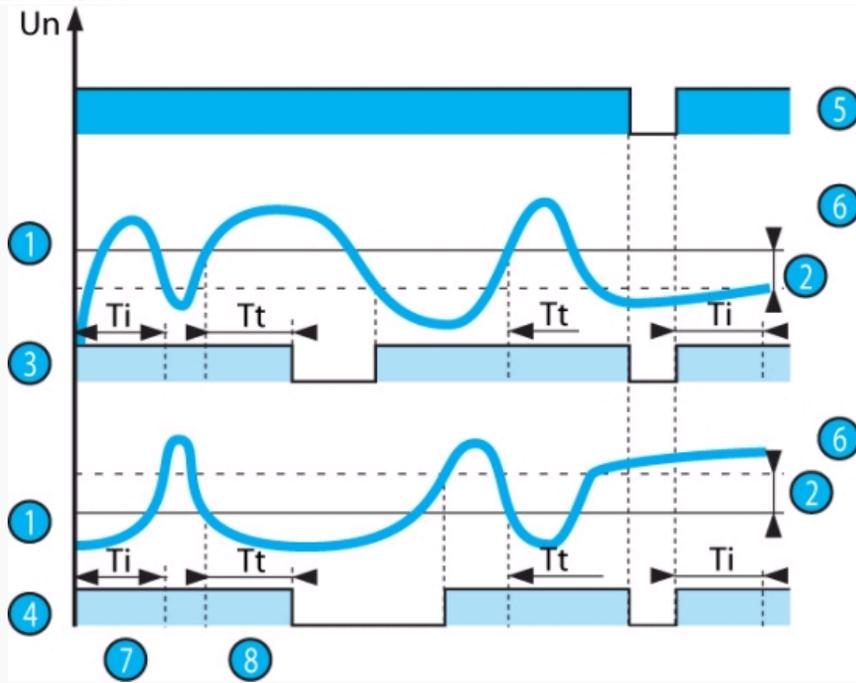
Si le mode "avec mémoire" est sélectionné, le relais s'ouvre et reste dans cette position lorsque le franchissement du seuil est détecté. Il faut couper l'alimentation pour réarmer le produit.
